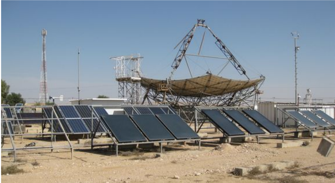
Wissenschaftler des Fraunhofer ISE untersuchen die Alterung von Solarkollektoren, hier in der israelischen Wüste Negev. © Fraunhofer ISE
